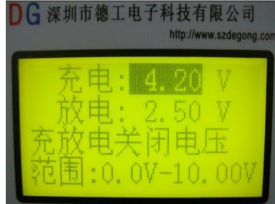
(16)、容量测试设置——关闭电压
