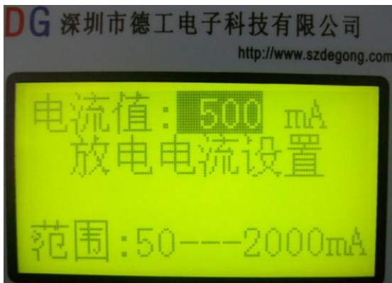
(15)、容量测试设置——放电电流
