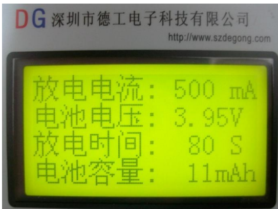
(18)、容量测试设置——容量测试中...
