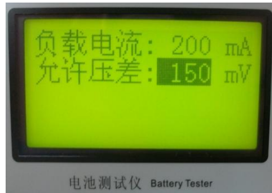
(2)、负载电压测试设置
